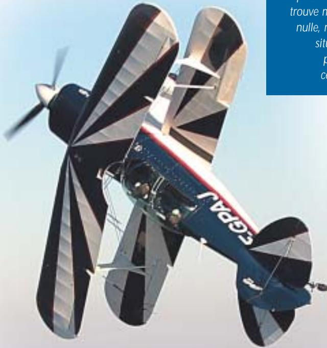
Quand un avion de voltige est en phase de renversement, il se trouve maintenu à une vitesse nulle, mais qu'il n'est pas en situation de décrochage, puisque l'incidence est celle de portance nulle.
