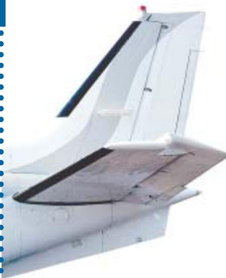
*La FAA a tiré la sonnette d'alarme au vu du nombre considérable de décrochages de la profondeur en conditions givrantes d'avions souvent biturbopropulseurs. Ceci a d'ailleurs généré des CN pour tout avion à dégivrage pneumatique, du Piper Seneca au Cessna Citation.*
